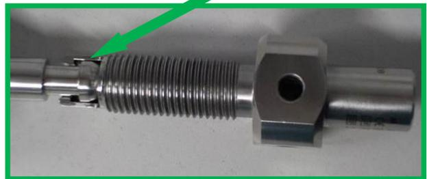
Puis glisser cette unité vis de pression-mandrin dans le tube de guidage de l'adaptateur (c) et visser en faisant d'abord seulement deux ou trois tours. Veiller ce faisant à la bonne position de la surface du mandrin ; **la flèche située sur l'adaptateur et le mandrin doivent se faire face**.
