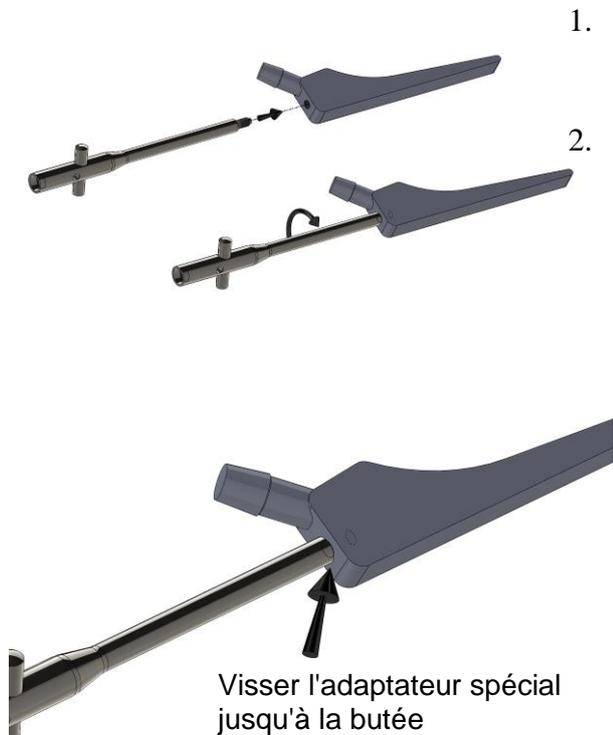
La forure située sur la tige de hanche doit être bien dégagée et accessible. De même, il faut que la forure ne présente pas de tissus incarnés. Afin d'assurer un bon raccord entre l'implant et l'instrument, il faut que l'adaptateur spécial puisse être **entièrement vissé, jusqu'au fond de la forure**. S'il n'y a pas assez de filets, l'adaptateur spécial risque de se détacher.
