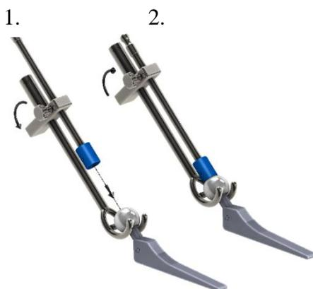
Enfiler l'outil d'extraction de tête fémorale autour de la tête fémorale (1). L'orienter de manière à ce que la tête fémorale puisse être retirée par le cône (sens de la tige). Dévisser la vis, abaisser la tige sur la tête fémorale, et presser avec le pouce. Visser la vis de blocage fermement à la main (2).
