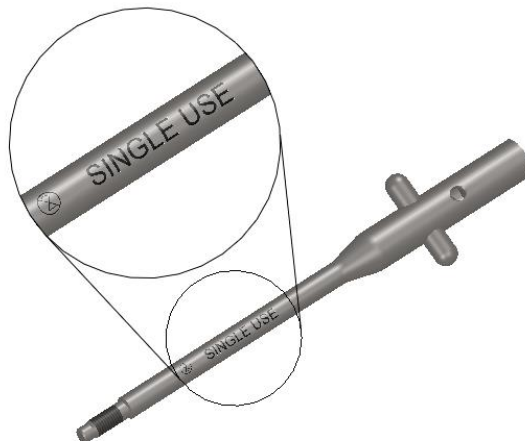
Abb. 17: Beschriftung auf den Einweg-Spezialadaptern
