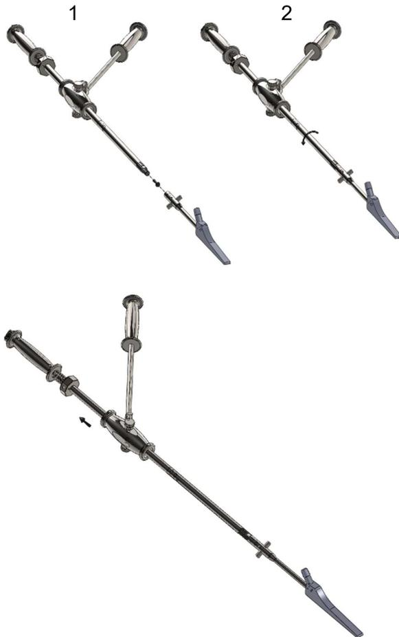
Schrauben Sie nun das Extraktionsinstrument an den Spezialadapter. Halten Sie den Schlagkörper und das Gewicht fest und drehen Sie das Extraktionsinstrument wie abgebildet (Pfeil) um seine Achse.
