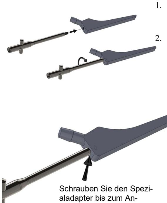
Das Bohrloch am Hüftschaf muss gut freigelegt und zugänglich sein. Das Bohrloch muss zudem frei von Gewebe sein. Um eine gute Verbindung zwischen dem Implantat und dem Instrument herzustellen, muss der Spezialadapter bis zum **Ende der Bohrung vollständig** eingeschraubt werden. Sind zu wenig Gewinde im Implantat im Eingriff, kann der Spezialadapter ausreißen.
