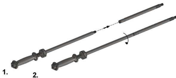
Schrauben Sie die Führungsstange von Hand (kein Werkzeug verwenden!) in die entsprechende Verlängerungsstange ein und ziehen Sie diese von Hand fest.
