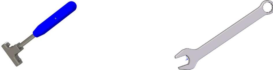
**Abb. 15:** Tool zu RAP-hip Basisset (links), 11mm AF-Maul-/ Ringschlüssel (rechts)
