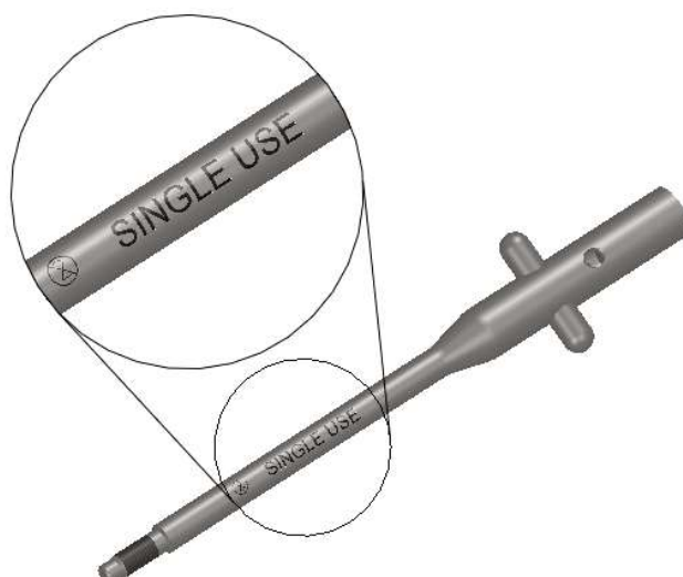
Figure 2: Esempio di etichettatura sui componenti del dispositivo
