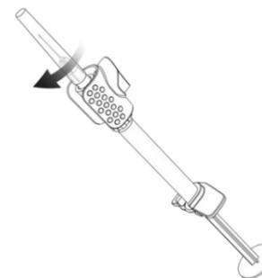
**⚠** Atenção: utilize apenas uma agulha de espaço zero. A utilização de qualquer outro tipo de agulha pode originar uma subdosagem. A seringa pré-cheia e a agulha têm de ser firmemente montadas no dispositivo de dosagem pediátrico Picleo para evitar fugas e uma separação acidental. Tenha o cuidado de não pressionar a haste do êmbolo da seringa durante a montagem.
